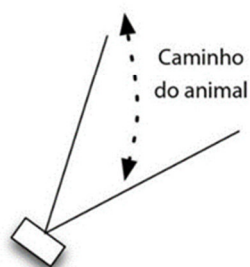
Figura 141. Representação do método adequado de instalação das armadilhas fotográficas
