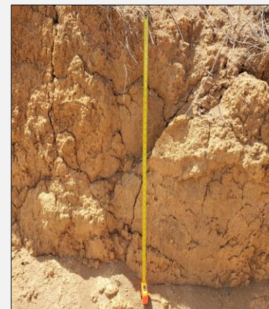
Figura 39. Perfil de Latossolo vermelho-amarelo na seção intermediária do Aterro. Vertente rompida por cisalhamento, ocupado por plantação de café na AID.
